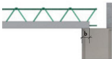
**$b \geq 2$  cm sur un appui béton armé**
