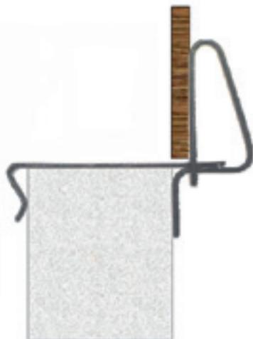
**⚠ Les poutrelles ne doivent pas reposer sur les clips de coffrage. La position des clips tiendra donc compte de celle des poutrelles.**
